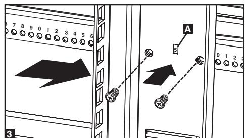
El fondo de los 2 rieles para el manejo de cables pueden ajustarse usando el mismo método.
