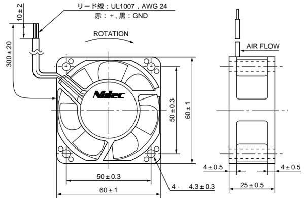
使用材料   ハウジング : プラスチック (UL : V-0)
